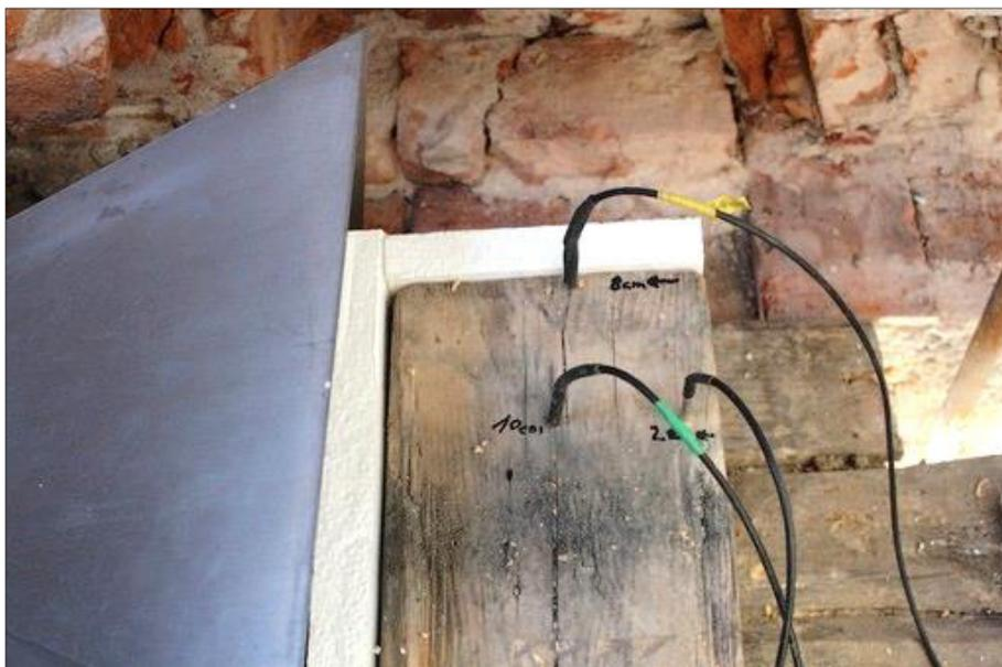
Abb. 26: Deckenbalken im Behandlungsabschnitt 1.1 mit eingesetzten Messfühlern
