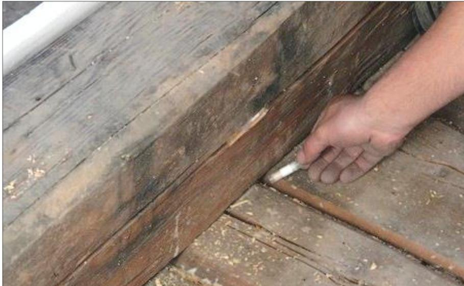
Abb. 36: Einsetzen eines Prüfkörpers aus Versuch 1 in die Fuge zwischen Deckenbalkenunterseite und Schalung (Foto: Baumann-Ebert)
